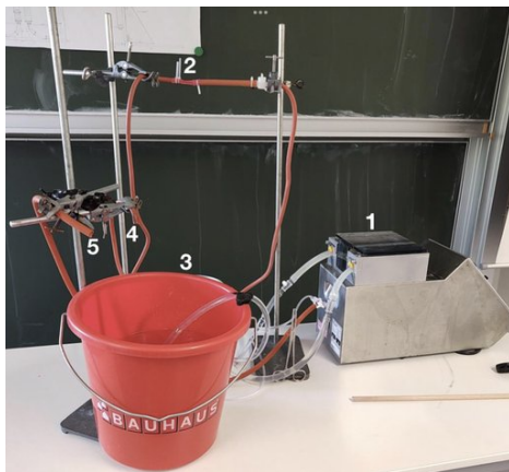
Aufbau des Windkesselmodells: 1 Pumpe, 2 Wasserballon als Aortenmodell, 3 Eimer, 4 Auslass ohne Windkesselleffekt, 5 Auslass mit Windkesselleffekt
