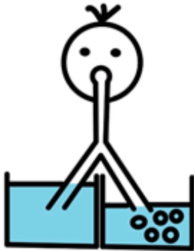
Schweredruck bei unterschiedlicher Füllhöhe und gleicher Flüssigkeitsdichte
