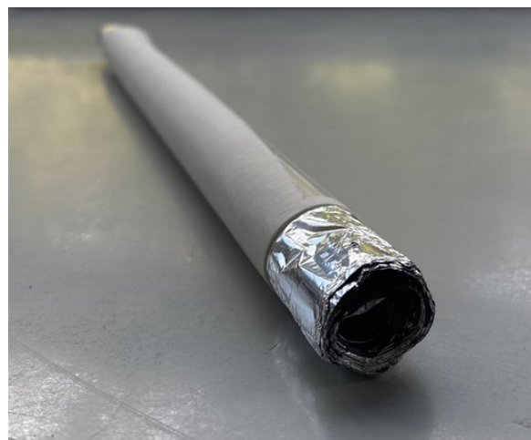
So sahen unsere selbst gebauten Wickelkondensatoren aus.
