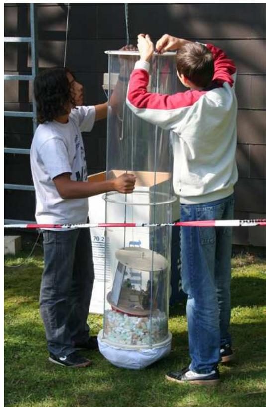
Die äußere Fallkapsel vor dem Hochziehen. Man erkennt im Inneren die kleinere Experimentierkapsel.
