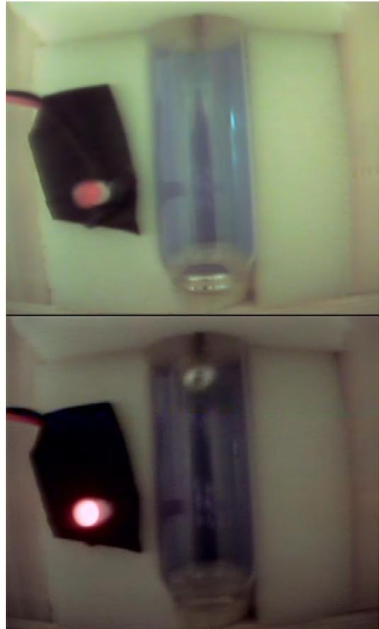
Unter seiner eigenen Gewichtskraft formt sich der Quecksilbertropfen zu einer Linse (oben). In Mikrogravitation (unten) zieht er sich so schnell zu einer Kugel zusammen, dass er hochschnellt. Die rote LED zeigt an, dass Mikrogravitation herrscht.
