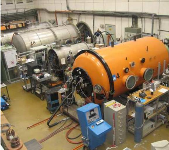
Abbildung 24: Maschinen im Institut für Raumfahrtssysteme Stuttgart zur Simulation der Bedingungen beim Eintritt von Satelliten in Planetenatmosphären.
