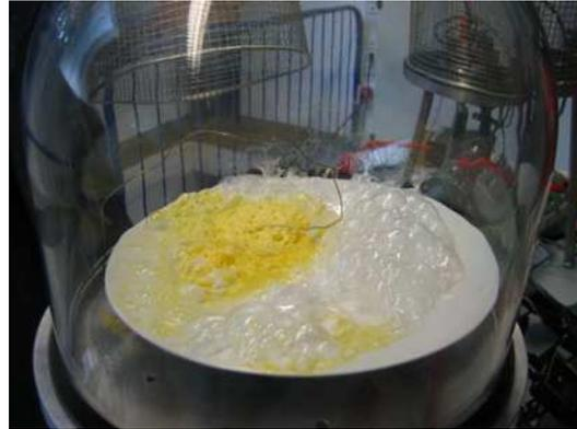
Eigelb und Eiweiß werfen im Vakuum Blasen, die nach wenigen Minuten gefrieren.
