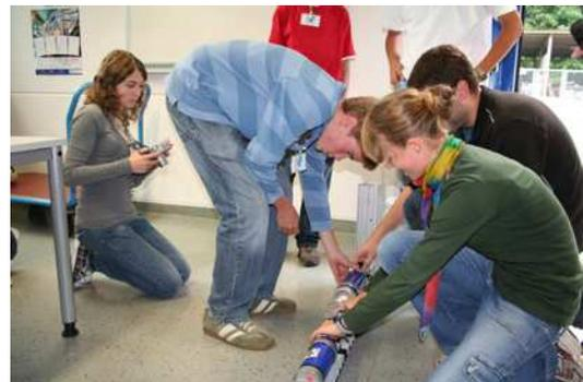
Auf einer geraden Strecke aus Modelleisenbahnschienen, auf der zwei Wagen mit ferngesteuertem Druckluftantrieb standen, wurde getestet, bei welcher Zündungsart der vordere Wagen am weitesten fuhr. Nach vielen Versuchen erkannten wir, dass die Zündung nacheinander stattfinden muss, um am effizientesten die Druckluft, oder in Realität den Treibstoff, nutzen zu können.
