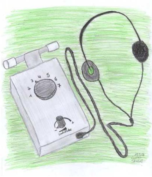
So sieht ein solches Peilgerät aus. Es hat zwei Drehschalter: Am größeren (oben) kann man einstellen, welchen Sender man anpeilt; am kleineren Schalter (unten) lässt sich die Lautstärke regulieren.
