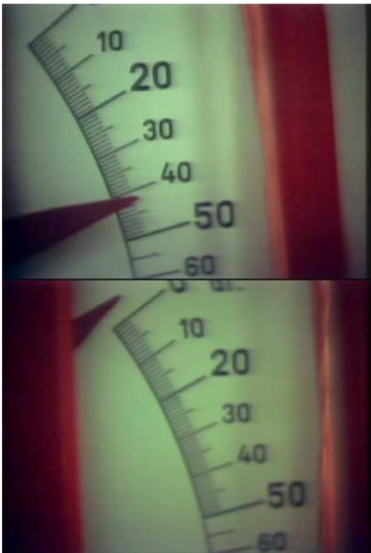
Unter Schwerkraft (oben) zeigt die Briefwaage etwas über 40 g an, in Mikrogravitation (unten) dagegen –5 g.
