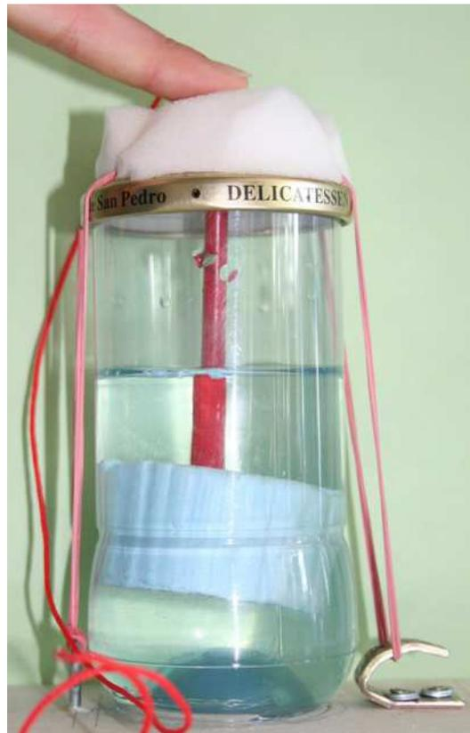
Hierbei befand sich ein Styroporstück in einem mit Wasser gefüllten Schraubglas. Unter normalen Bedingungen treibt das Styropor an der Wasseroberfläche. Wird es unter Wasser gedrückt, steigt es zur Wasseroberfläche zurück. Dieses Verhalten wollten wir unter Mikrogravitation testen. Hierfür musste sich das Styro-
