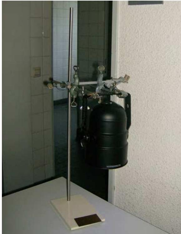
Doch nachdem dies endlich erledigt war, ging es richtig los: Wir arbeiteten schichtweise in der „Dunkelkammer“, um die Platinen 2–20 min zu belichten und zu überwachen. Wir haben zugleich mit verschiedenen Abständen (15 cm bis 50 cm) zwischen Platine und Lampe experimentiert.
