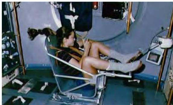
Abbildung 23: Astronautin auf einer Schwingungswaage im Raumlabor Skylab (Bild: NASA)
