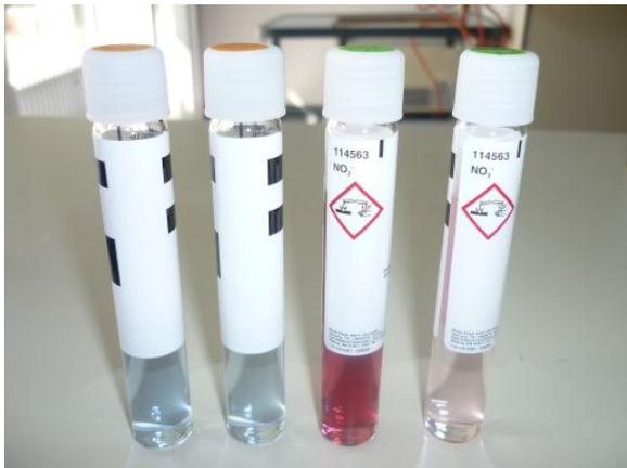
Abb. 19: Die blau gefärbten Küvetten zeigen den Phosphat-Nachweis, die rot gefärbten Küvetten den Nitrat-Nachweis.
