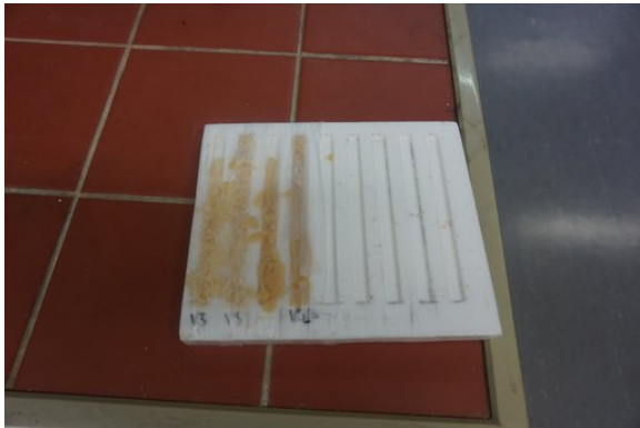
Formen für Strands mit 4 gegossenen Treibstoffen
