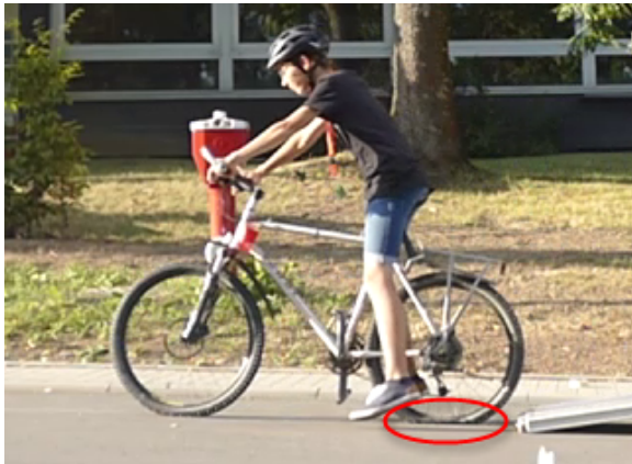
Rot markiert: stark schwingender Reifen kurz nach Verlassen der Rampe
