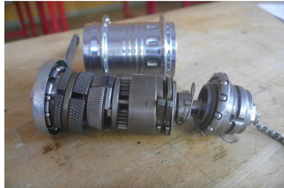
Nabenhülse und Innenleben der Schaltung
