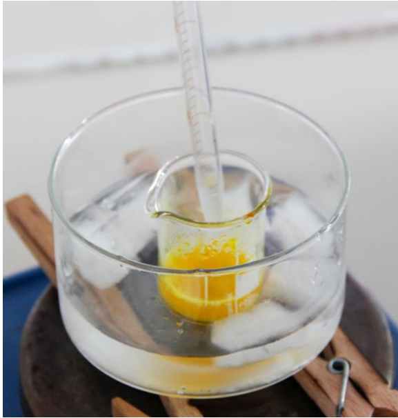
Abbildung 7: Nanopartikelherstellung: Zutropfen von kaltem, destilliertem Wasser im Eisbad
