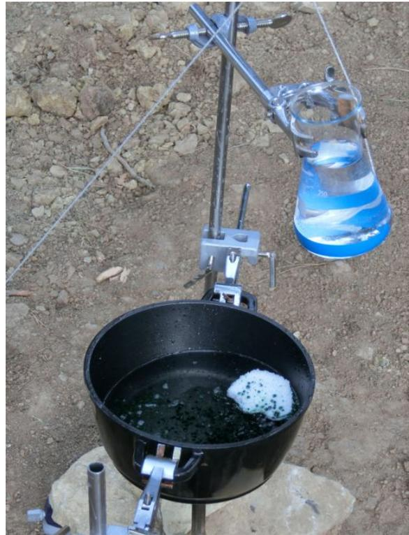
Unser Wachs-Wasser-Vulkan: Die Konstruktion mit der Schnur dient zum Eingießen des Wassers.
