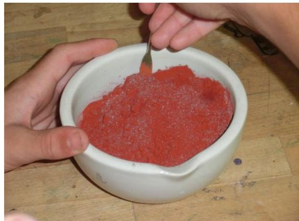
Thermit-Gemisch (Aluminium und Eisenoxid), zusätzlich mit Magnesiumpulver versetzt.
