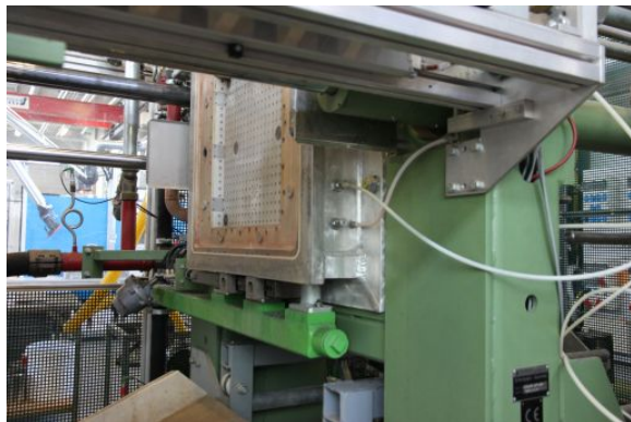
Geöffneter Formteilautomat, zu sehen ist die massive Sinterform
