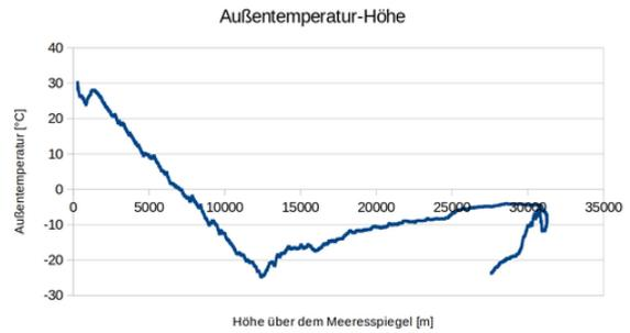
Abbildung 27: Außentemperatur in Abhängigkeit der Höhe
