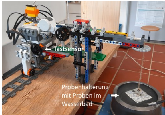
Abb. 23: Unser fertiger PCR-Roboter, die Probenhalterung befindet sich gerade in einem der drei Wasserbäder
