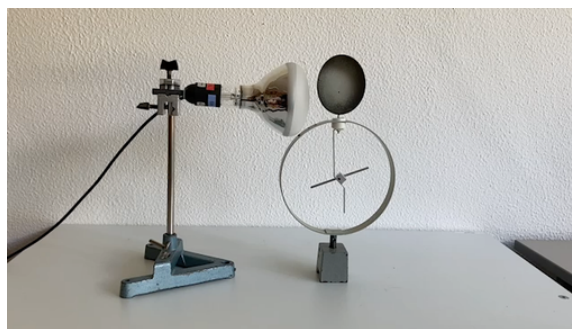
Versuchsaufbau zum Hallwachsversuch.
